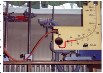
Staurohr verbunden ist, die Messung von Strömungsgeschwindigkeiten erlaubt, und das Gebläse. Hierbei kam ich zu dem Ergebnis, dass am Staupunkt die Strömung stark abgebremst wird, so wie wenn sie auf eine Mauer treffen würde. Am obersten Profilpunkt, an dem ich die Strömung als
