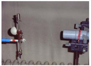
Um den Versuch nun durchzuführen, wurde der Testkörper gegenüber dem Gebläse, das darauf gerichtet war, angebracht. Nach einer anfänglichen Messung der Strömungsgeschwindigkeit traf die Luftströmung ungehindert auf den Körper. Der Versuch wurde so lange fortgeführt, bis der horizontal angebrachte Kraftmesser auf der anderen Seite des Drahtes einen konstanten Wert angezeigt hat.
